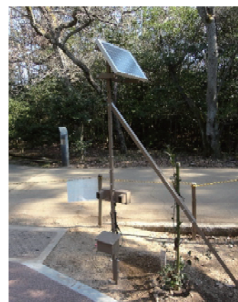
図 5-33 カウンターの整備事例 (屋島：香川県高松市)
